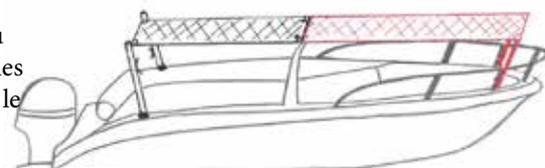
Grâce à notre système flexible, nous avons mis au point une solution pour tous les bateaux de sport et les voiliers courants. Le tube télescopique permet 6 possibilités de réglage différentes.
