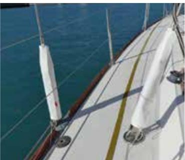
**Keine zerrissenen Segel und keine Verletzungen mehr durch ungeschützte Wantenspanner!**
